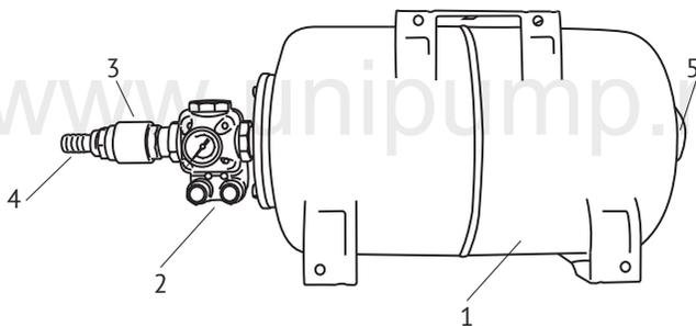
Комплект состоит из гидроаккумулятора (1), емкостью 5 или 24 л и блока автоматики (2), состоящего из реле давления и манометра. На выходе блока автоматики установлен обратный клапан (3) и штуцер для присоединения гибкого шланга (4).
